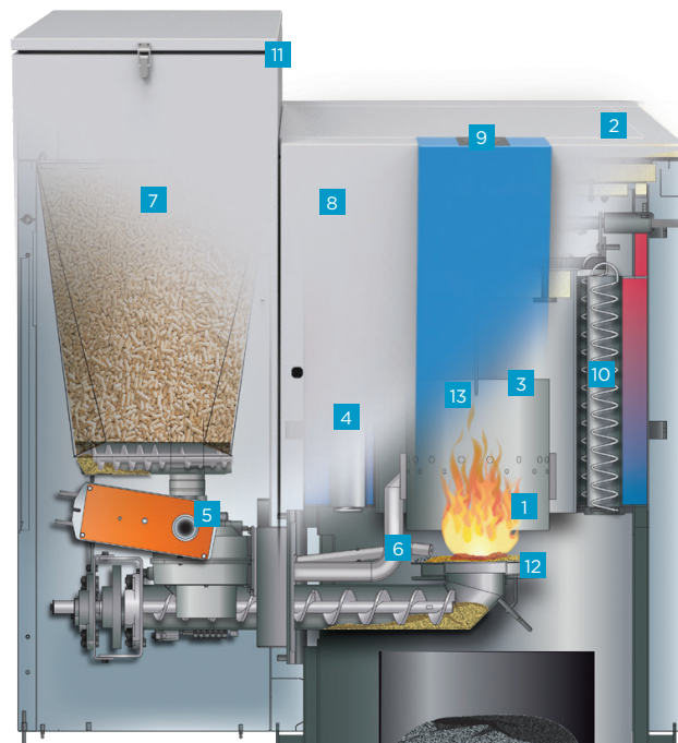
01 Quemador con sistema RCB (Re Circulating Burner)
